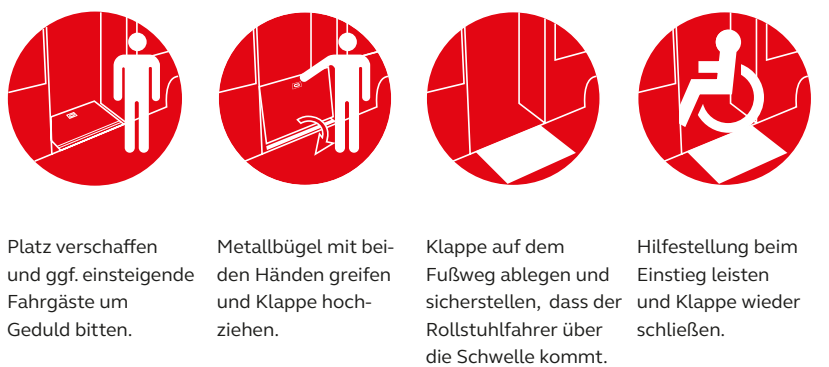
Über die klappbare Rampe in den Bus: So können Fahrgäste helfen.
